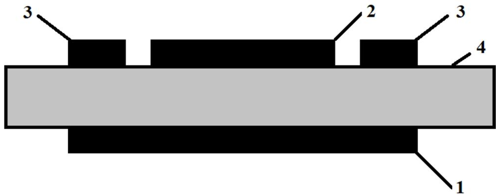
Рис. 1.2 Трехэлектродная система по ГОСТ 22372-77
