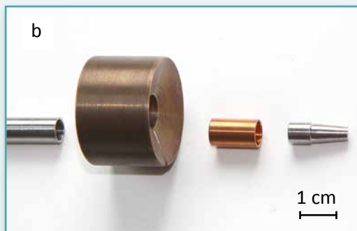
Схема магнитно-импульсной сварки (а) и фотография деталей: стальной трубы, соленоида, медного лайнера и заглушки (б) Magnetic pulse welding scheme (a); view of the parts: steel tube, coil, copper driver, and plug (b)
