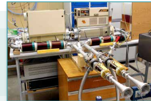
Двухканальный генератор из синфазных квазистационарных ЛОВ (37 ГГц) с мощностью излучения в канале ~100 MW на основе ускорителей РАДАН-303
