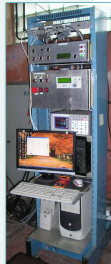
Стойка управления ускорителя UPT-1M Control panel of the URT-1M accelerator
