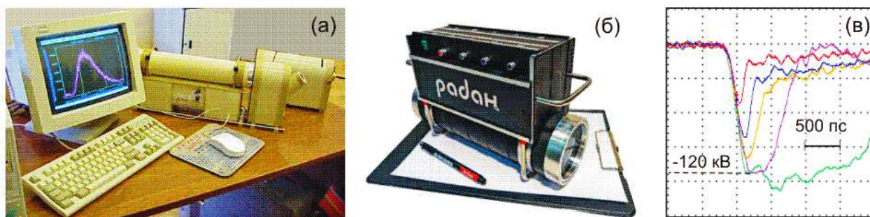
Рис. 49. (а) Импульсный катодолуминесцентный спектроскоп CLAVI на основе драйвера РАДАН-ЭКСПЕРТ с отпаянным вакуумным электронным диодом ИМА3-150Э. (б) Современная версия наиболее компактного 2-нс драйвера РАДАН-А4, обеспечивающего на 50-омной нагрузке (ПЛ) формирование импульсов (в), укорачиваемых коаксиальным атмосферным разрядником рис. 45а в режиме инициирования с УЭ (Рис. 45в).
