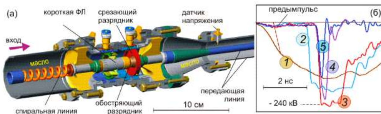
Рис. 3. (а) Конструкция субнаносекундного преобразователя-компрессора импульсов с ФЛ и азотными разрядниками. (б) Выходные импульсы напряжения: 1 – при выключенных разрядниках; 2, 3 – при различной длине ФЛ и выключенном срезающем разряднике; 4, 5 – при срабатывании обоих разрядников.
