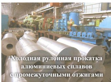
Холодная рулонная прокатка алюминиевых сплавов с промежуточными отжигами
